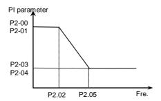
Figure 6-2 PI parameter diagram
