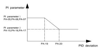
Figure 6-25 PID parameter switching diagram
